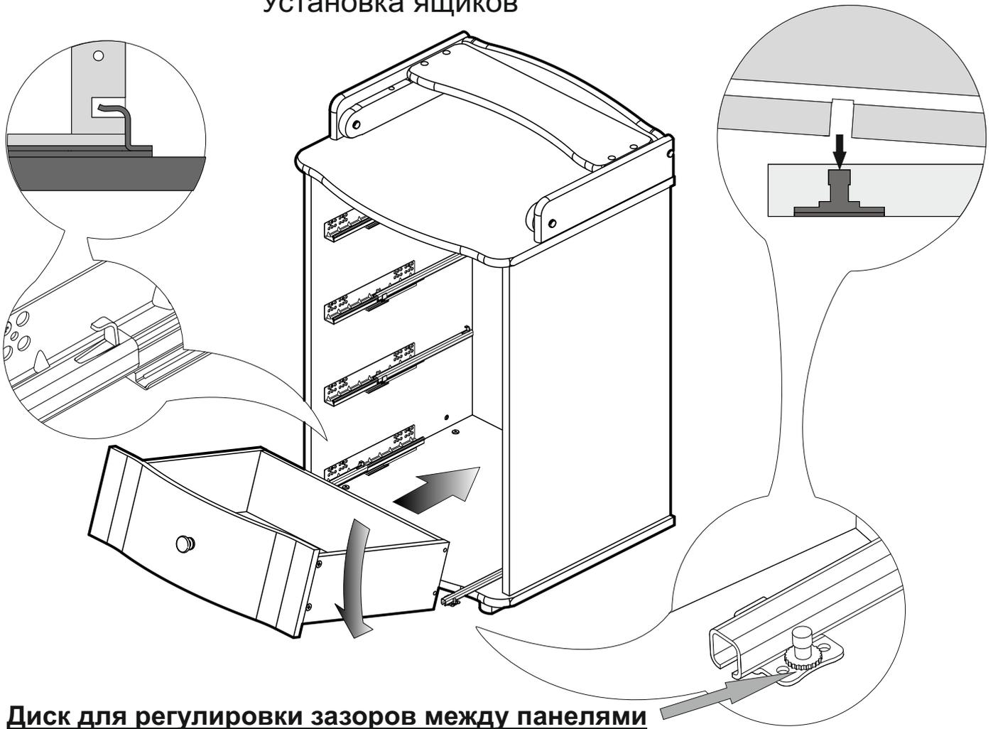
Диск для регулировки зазоров между панелями
