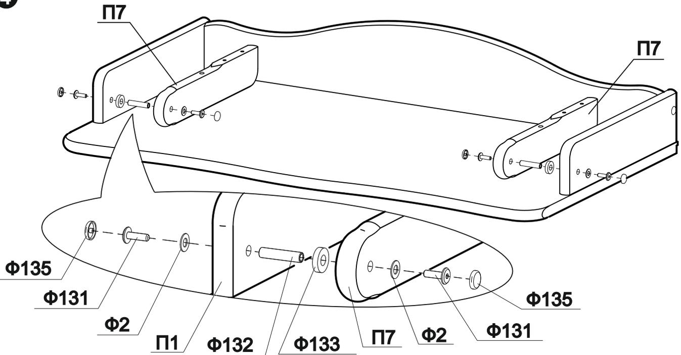
Если в процессе эксплуатации винты М6х20(Ф131) раскручиваются, нужно убрать одну или две шайбы(Ф2) и снова затянуть винты при помощи двух ключей шестигранных(Ф46)
